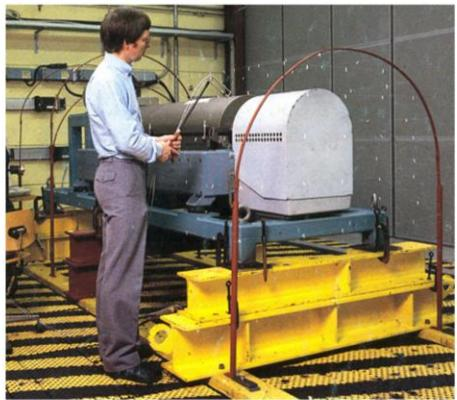
*Merenje normalne komponente intenziteta zvuka u diskretnim mernim tačkama, na površini koja potpuno obuhvata izvor buke, a u cilju određivanja njegove zvučne snage*
